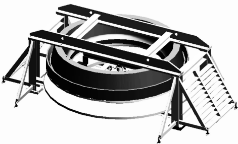
图 2 镜板研磨装置示意
