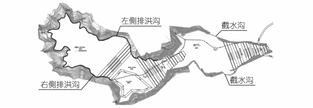
图 5 排水方案二布置示意
