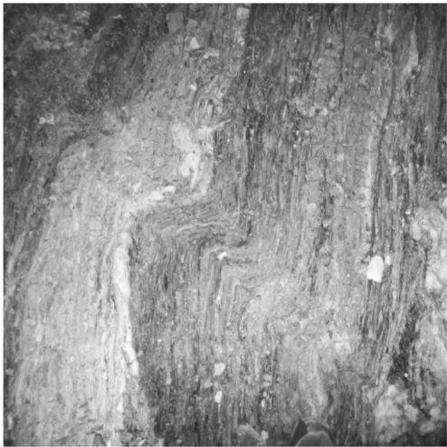
图 2 Pt_{2y} 地层典型照片(4 号导流洞桩号 0+230 附近底板)
