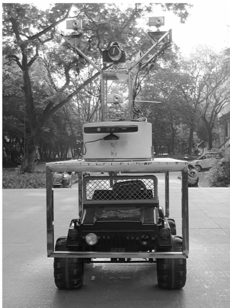
图 5 多源多目视觉无人车移动测量系统的集成
