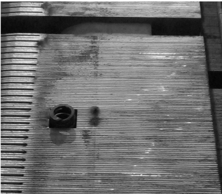
图 2 放电磁极对应磁轭上的放电痕迹
