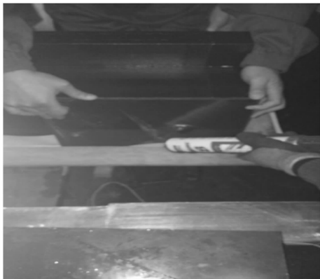
图 6 对线圈密封
